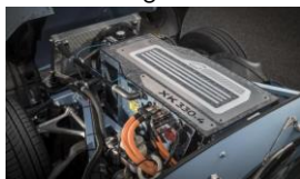
E-Type mit 190 KW E-Motor
